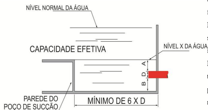
Figura B.2 - Tomada lateral de sucção para bomba principal
